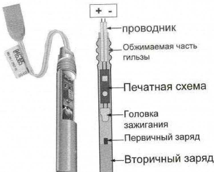
Рис. 3. Электронный детонатор *i-kon*<sup>™</sup>
