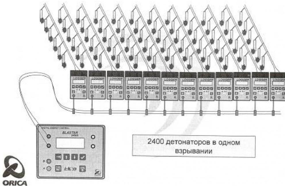
Рис. 5. Схема монтажа взрывной сети с использованием Логгеров и Бластера
