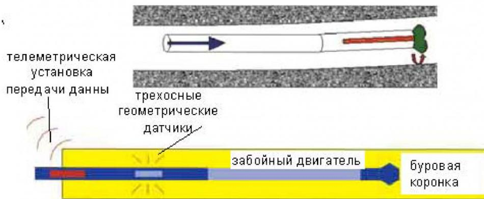
Рис. 1 . Схема снаряда для направленного бурения скважин по углю
