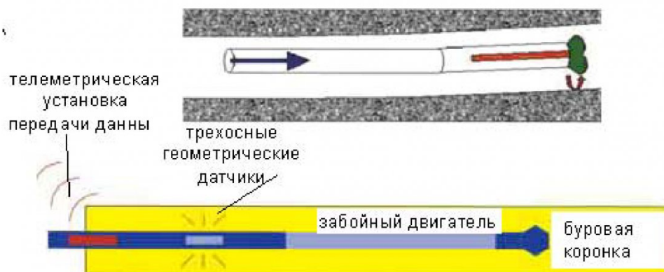
Рис. 1. Схема снаряда для направленного бурения скважин по уголю
