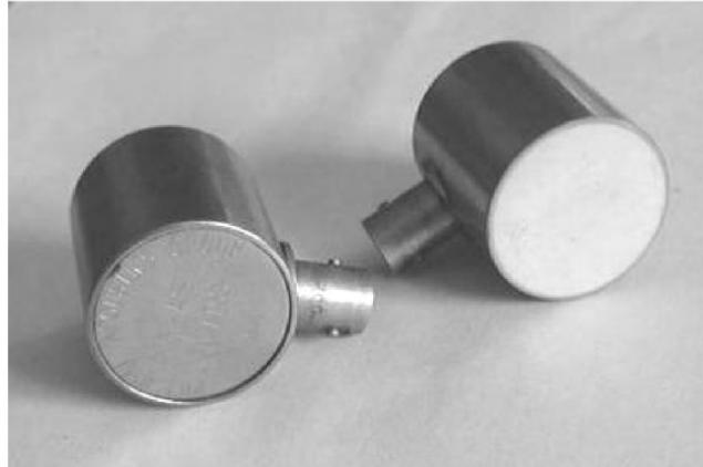
*Рис. 2. Датчик-предусилитель*
