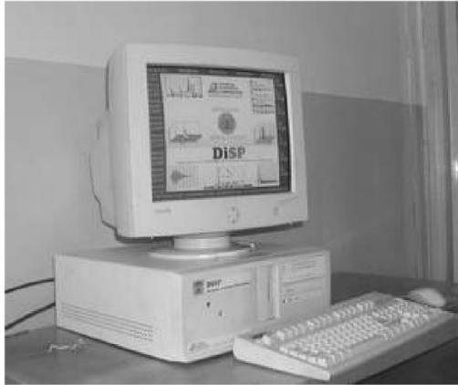
*Рис. 1. АЭ система DiSP16L*
