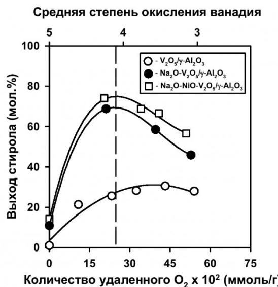
Рис. 5. Влияние степени восстановления нанесенных на  $\gamma\text{-Al}_2O_3$  ванадийсодержащих катализаторов на их активность при дегидрировании этилбензола.
