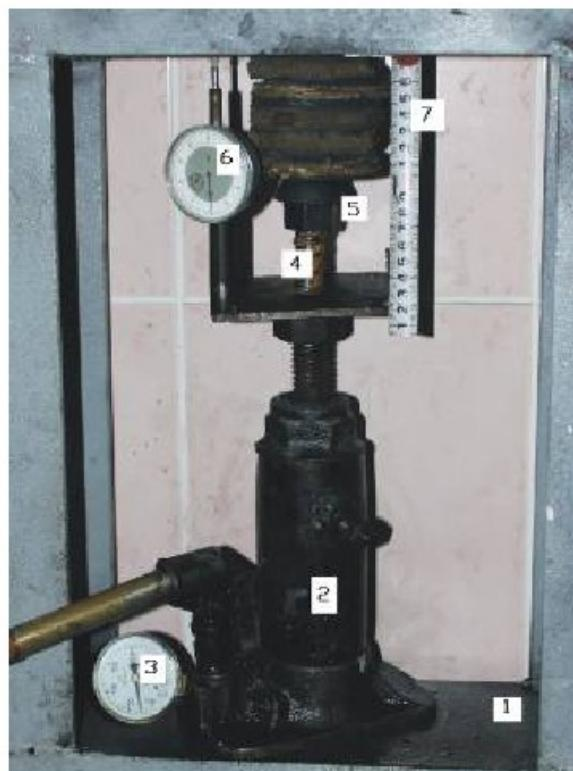
Рис.2. Устройство для испытания узлов податливости анкерных крепей
