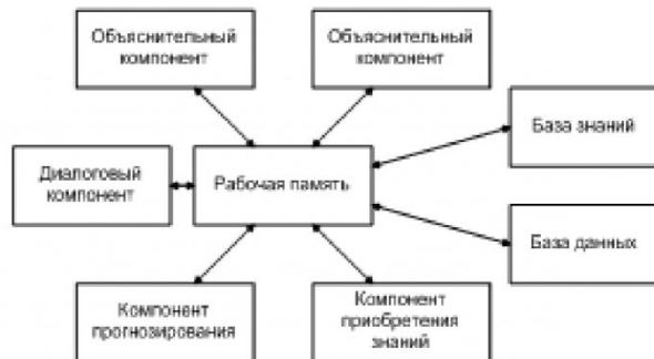
Рис. 2. Структура экспертной системы
