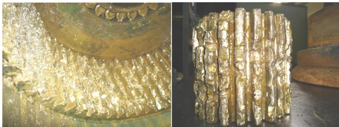
Рис. 4. Дефекты зубчатой передачи в волновом редукторе резания комбайна СМ-130
