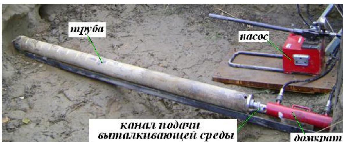
Рис.7. Экспериментальное оборудование для проверки работоспособности способа очистки трубы от грунтового керна
