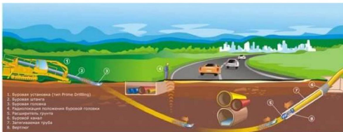
Рис. 2. Принцип работы установок ГНБ
