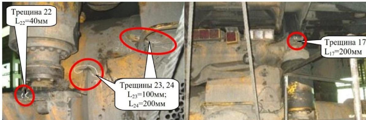
*Рис. 2. Трещина основного металла картера заднего моста в районе крепления цилиндра подвески и реактивной штанги БелАЗ 75131*
