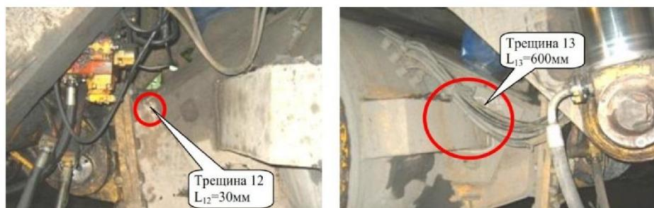
Рис. 1. Трещины сварных соединений левой и правой стороны воздухораспределительной коробки заднего моста автосамосвала БелАЗ-75131
