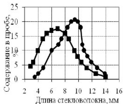
Рис. 6. Влияние геометрической формы канала на длину стекловолокна ( T_{\text{к}}=100^{\circ}\text{C} , T_{\text{н}}=20^{\circ}\text{C} , P_{\text{л}}=117,8 МПа) ● - Ø канала 5 мм; ■ - прямоугольный канал с размерами сечения 5x2,5 мм
