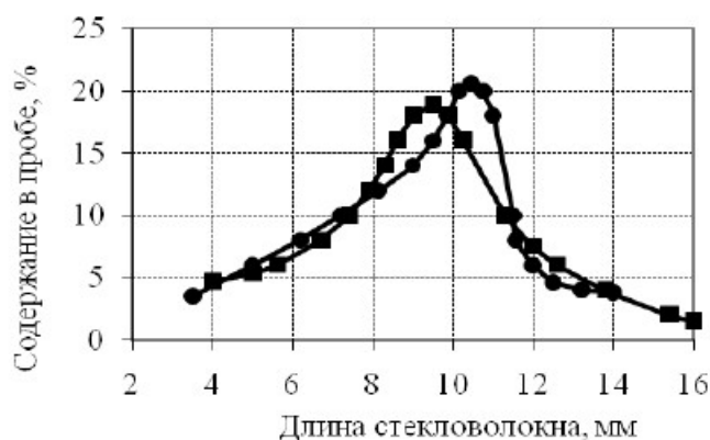
Рис. 7. Влияние давления литья на излом стекловолокна ● - P_{\text{л}} = 44,7 МПа; ■ - P_{\text{л}} = 87,4 МПа
