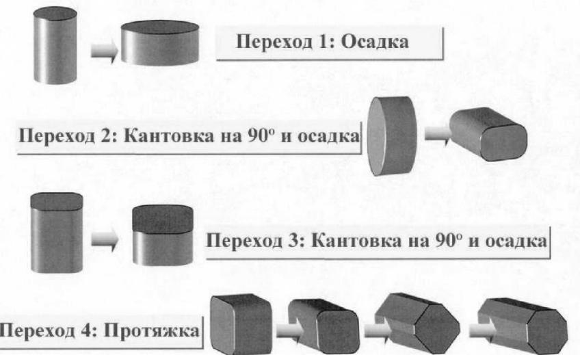
*Рис. 1. Метод интенсивной пластической деформации (всесторонняя ковка) для получения образцов с СМК структурой*
