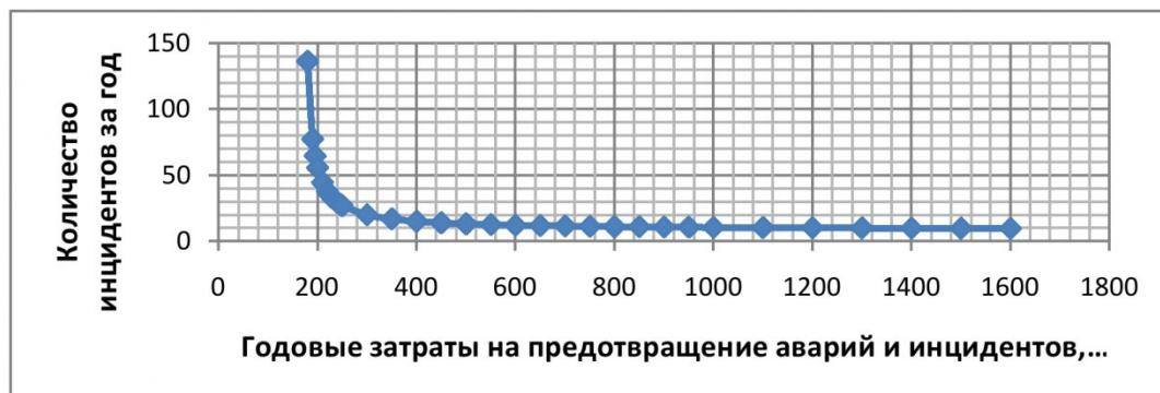
Рис. 3. Эмпирическая зависимость количества инцидентов  $N_{\text{инц.}}$  от  $Z_{\text{ав.}}$ , в млн. руб. в ОАО «ЮК ГРЭС».
