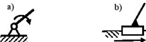
Рис. 2. Механизм первого класса с вращательной (а) и поступательной (б) парами
