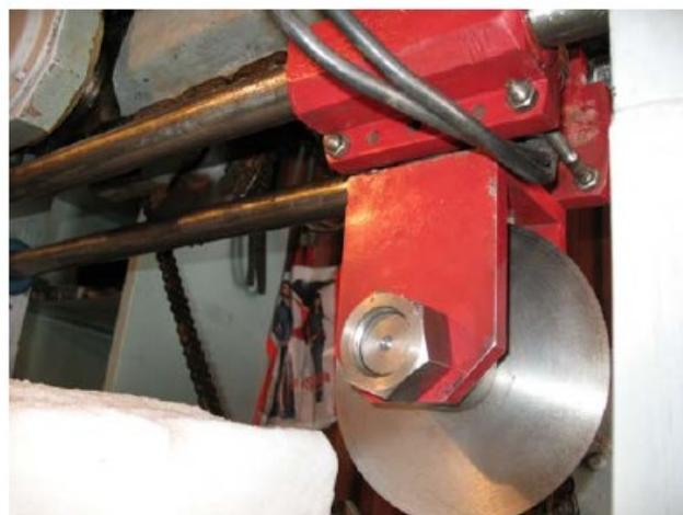
Рис. 2. Тензоэлемент установленный на лабораторном стенде в сборе с кронштейном и режущим инструментом
