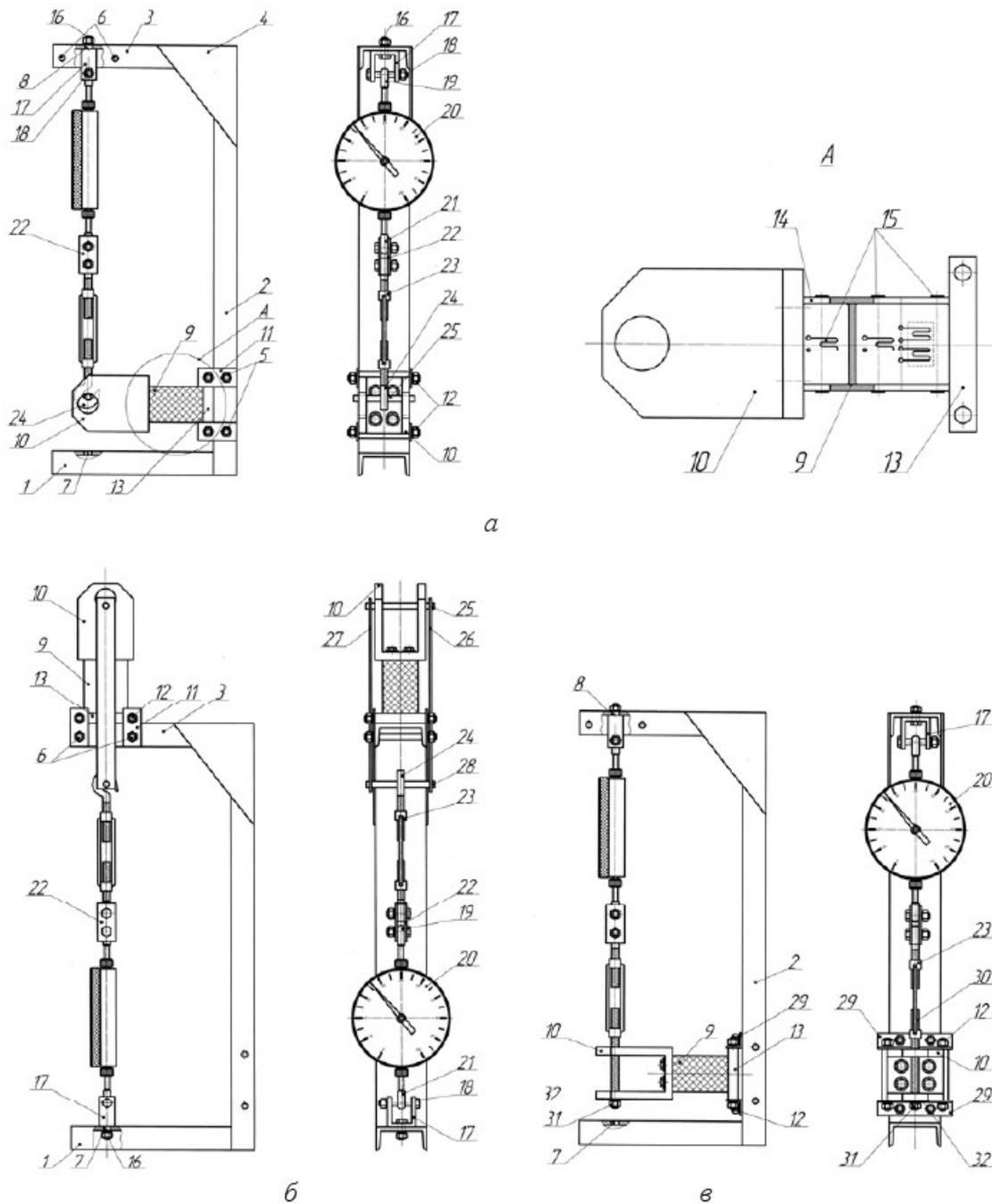
Рис. 3. Размещение элементов КЦ на тарировочном устройстве: а – при тарировке горизонтальной составляющей усилия резания; б – при тарировке вертикальной составляющей усилия резания; в – при тарировке боковой составляющей усилия резания
