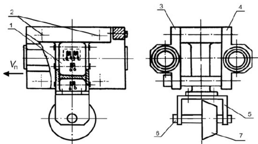
Рис. 1. Тензоэлемент лабораторного стенда: 1 – полая балка; 2 – шпильки; 3, 4 – щек; 5 – кронштейн; 6 – вал; 7 – режущий инструмент;  $V_n$  – направление подачи тензоэлемента
