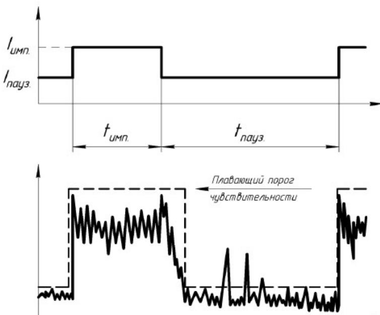
Рис. 3. Активность АЭ при сварке модулированным током
