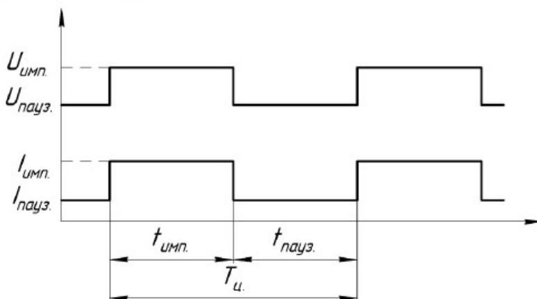
Рис. 1. Изменение энергетических параметров сварки при СМТ.
