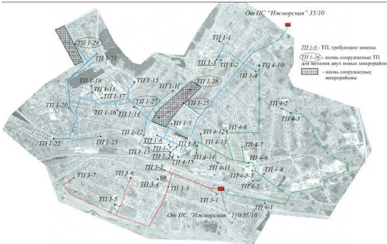
Рис.1. План распределительной сети 10 кВ п.г.т.Ижморский
