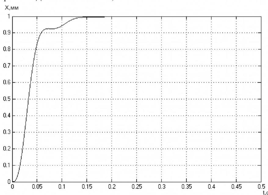
Рис. 4. График переходного процесса изменения координаты ЛД
