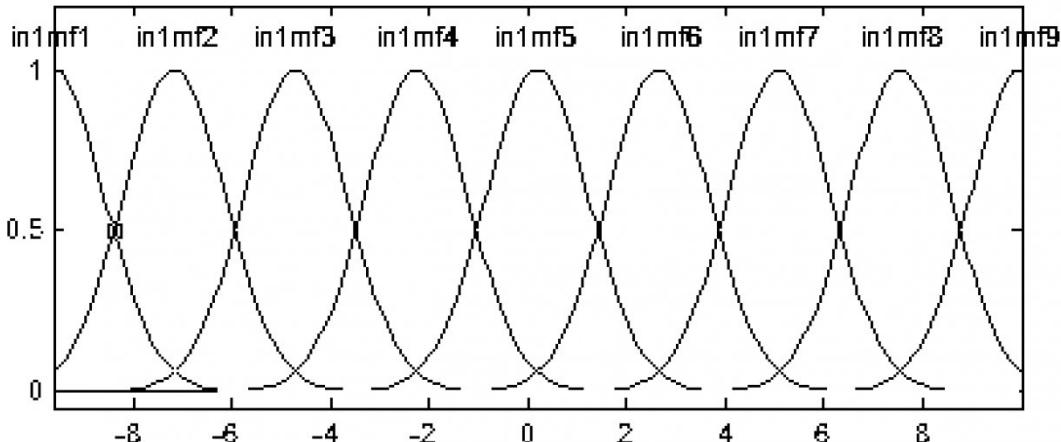
Рис. 7. Входная переменная сети в канале интегратора до обучения
