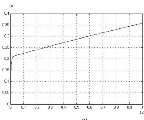
*Rис. 2. Графики переходных процессов изменения тока в обмотках двигателя*
