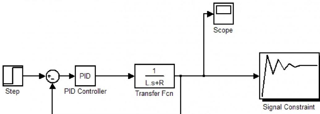
*Rис. 1. Simulink модель для настройки регулятора тока*
