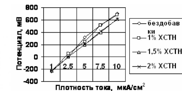
Рис. 4. Анодные поляризационные кривые стали в бетоне 1-го состава без пропаривания
