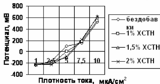
Рис. 2. Анодные поляризационные кривые стали в бетоне 1-го состава с пропариванием
