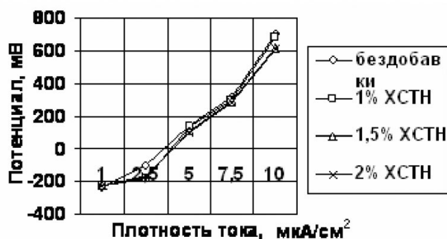
Рис. 5. Анодные поляризационные кривые стали в бетоне 2-го состава без пропаривания
