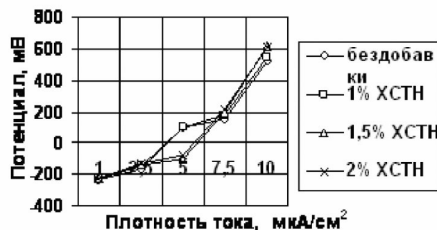
Рис. 3. Анодные поляризационные кривые стали в бетоне 2-го состава с пропариванием
