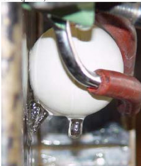
Рис. 4. Гидродинамика жидкости на вертикальной поверхности при контакте со сферой d = 40 мм, Re = 133
