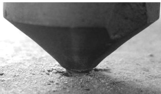
Рис. 4. Разрушение горной породы безлезвийным инструментом
