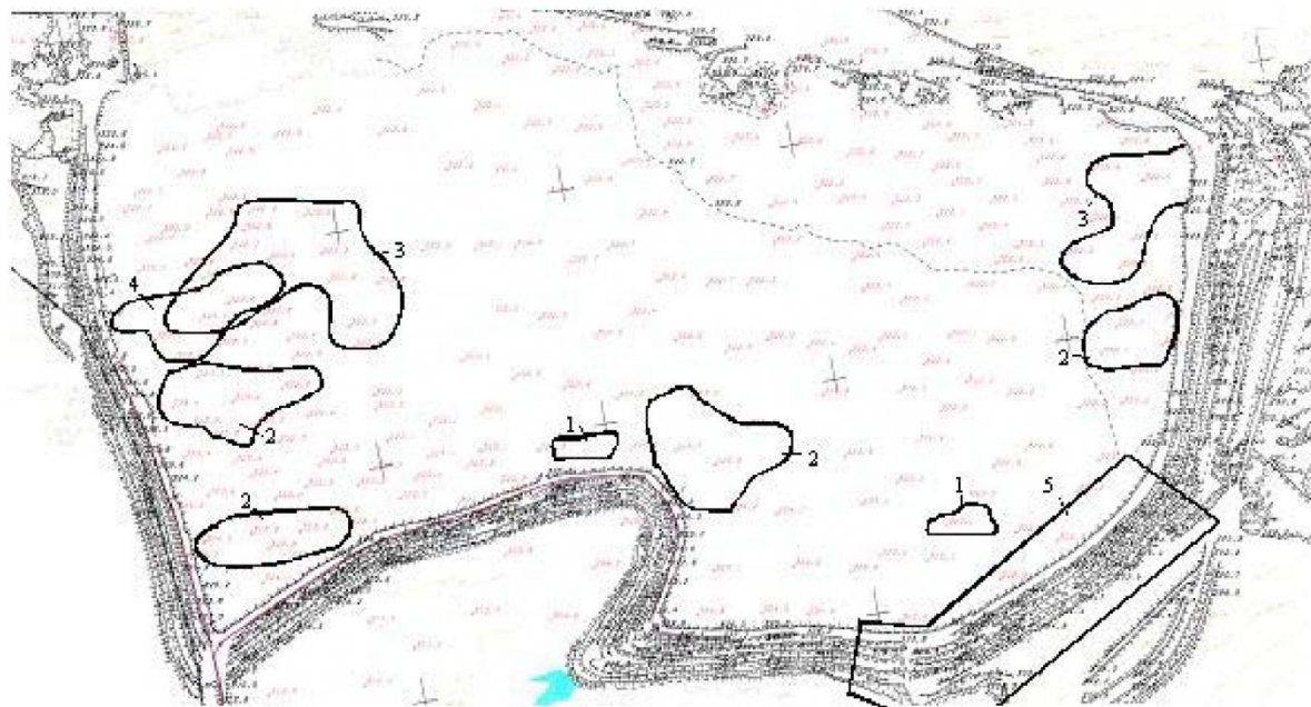
Рис. 6. Зоны горизонтальных сдвижений и оседаний техногенного массива гидроотвала "Прямой Ускат", выявленные по результатам мониторинга: 1 – оседания, 2005 г.; 2 – оседания, 2006 г.; 3 – оседания, 2007 г.; 4 – оседания, 2008 г.; 5 – горизонтальные сдвижения, 2005–2008 гг.
