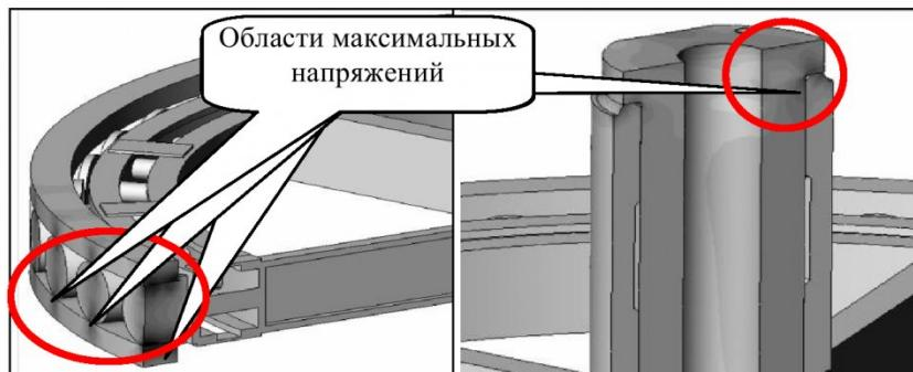
Рис. 3. Картина распределения эквивалентных напряжений по критерию Мизеса в элементах
