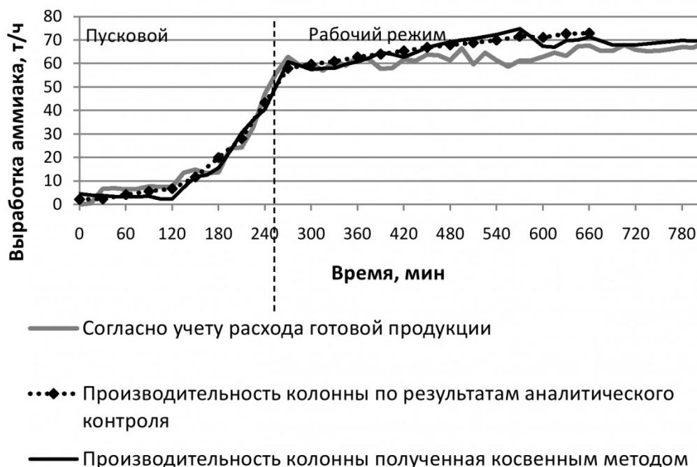
Рис.2. Оценка производительности колонны синтеза аммиака с использованием различных методик
