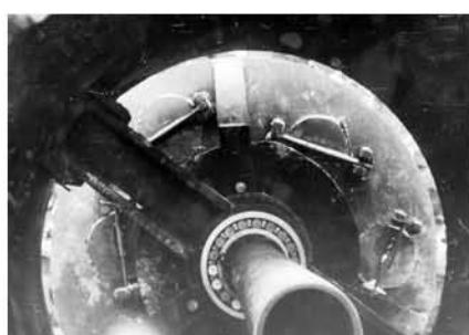
Рис. 3. Опорно-центрирующий узел с подшипником скольжения
