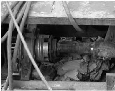
Рис. 5. Узел вращательно-поддающего механизма
