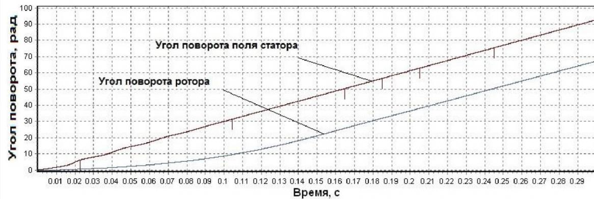
Рис. 2 Изменения угла поворота вектора  $\Psi_s$  и электрического угла поворота ротора АД
