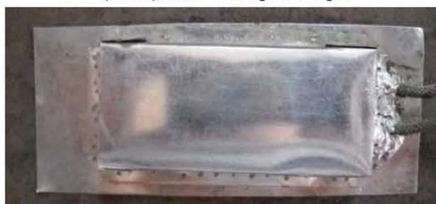
Рис.4. Привариваемый тензорезистор при позиционировании на металлоконструкции экскаватора
