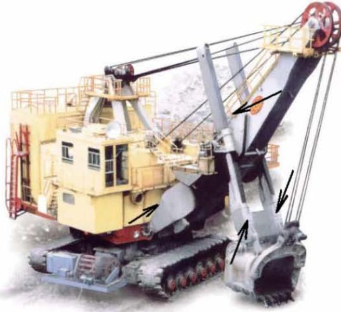
Рис.6. Места установки тензорезисторов на экскаваторе
