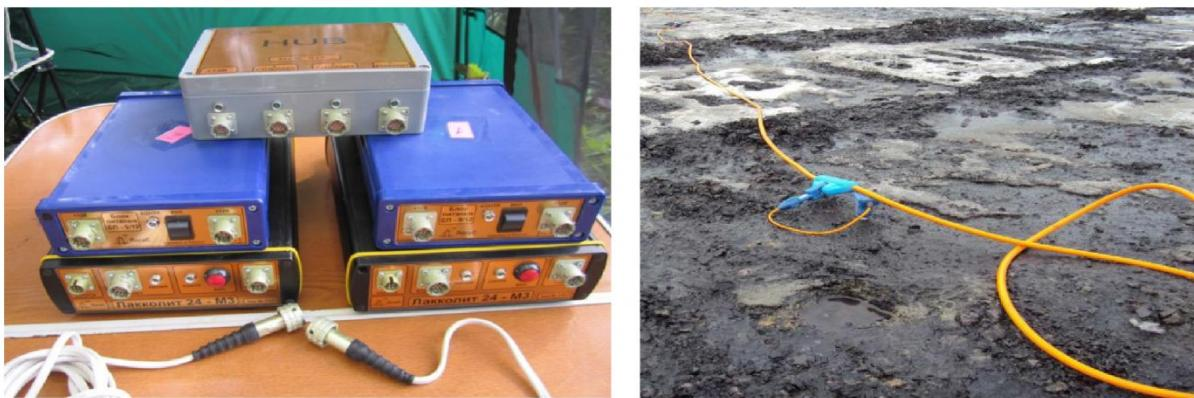
Рис. 3. Сейсморегистрирующий комплекс: а – станция «Лакколит-24-М3»; б – измерительная коса с геофонами
