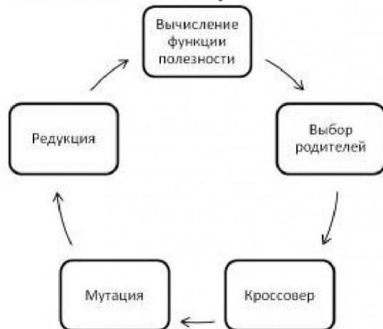
*Рис. 1. Общая схема генетического алгоритма*
