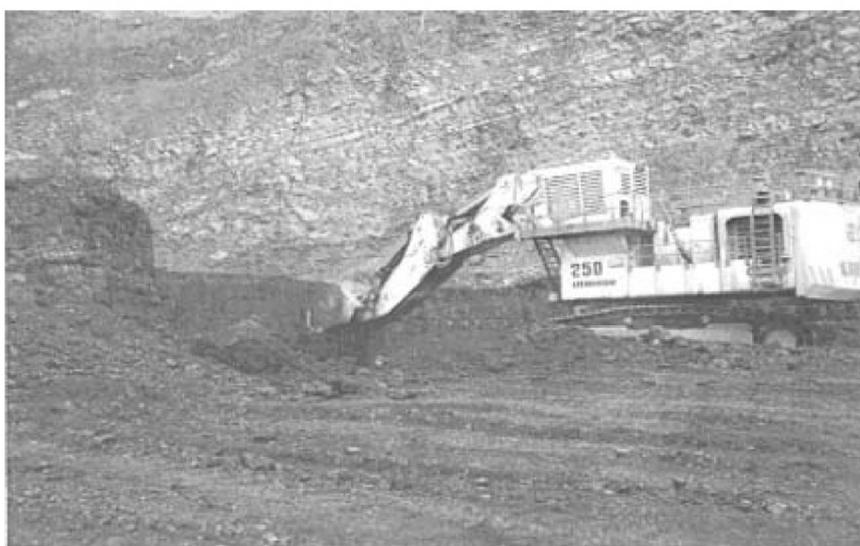
Рис. 4. Выемка пологопадающего угольного пласта (разрез «Талдинский»)
