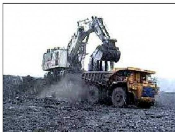
Рис. 2. Разгрузка ковша экскаватора в кузов автосамосвала при нижней погрузке (разрез «Караканский»)
