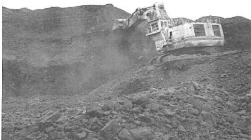
Рис. 3. Отработка вскрышиного уступа верхним черпанием (разрез «Талдинский»).
