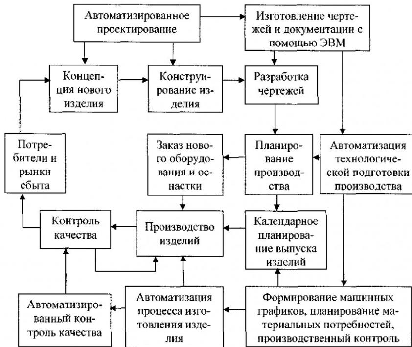
Рис. 2. Производственный цикл при автоматизированной поддержке
