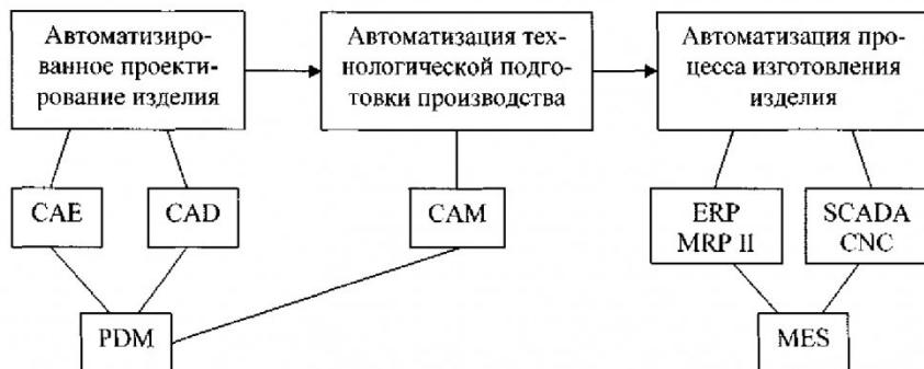
Рис. 3. Системы автоматизации производственным процессом
