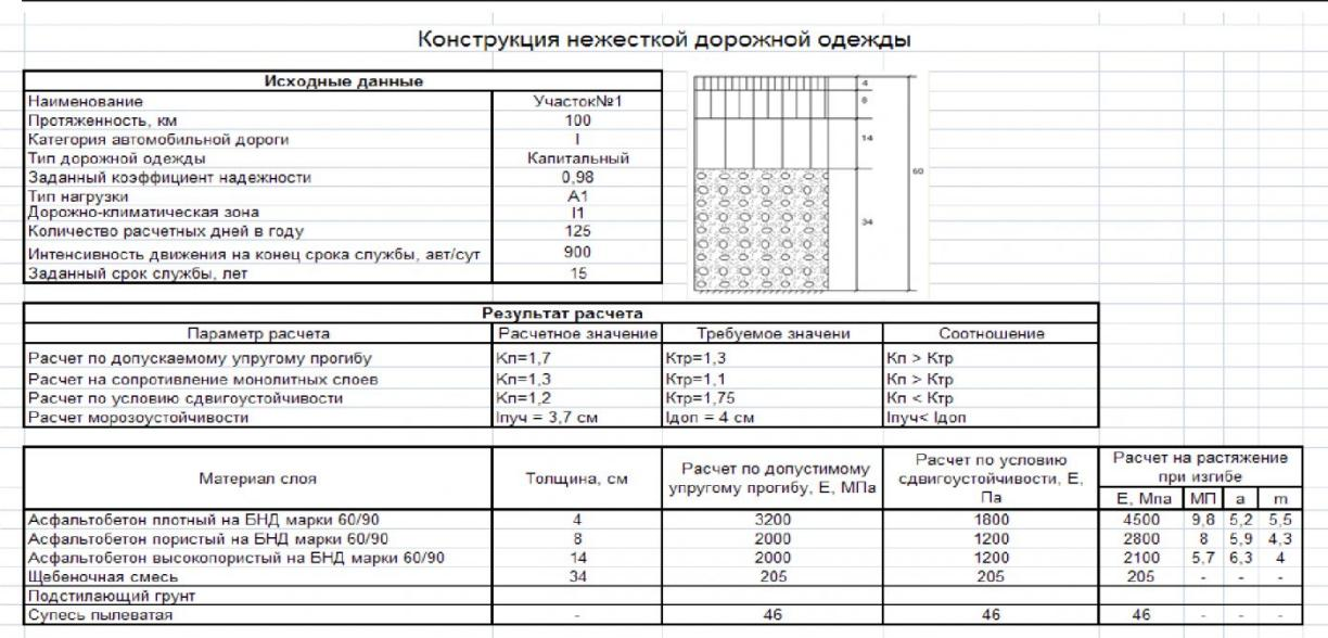
Рис. 8. Отчет о расчете конструкции нежесткой дорожной одежды
