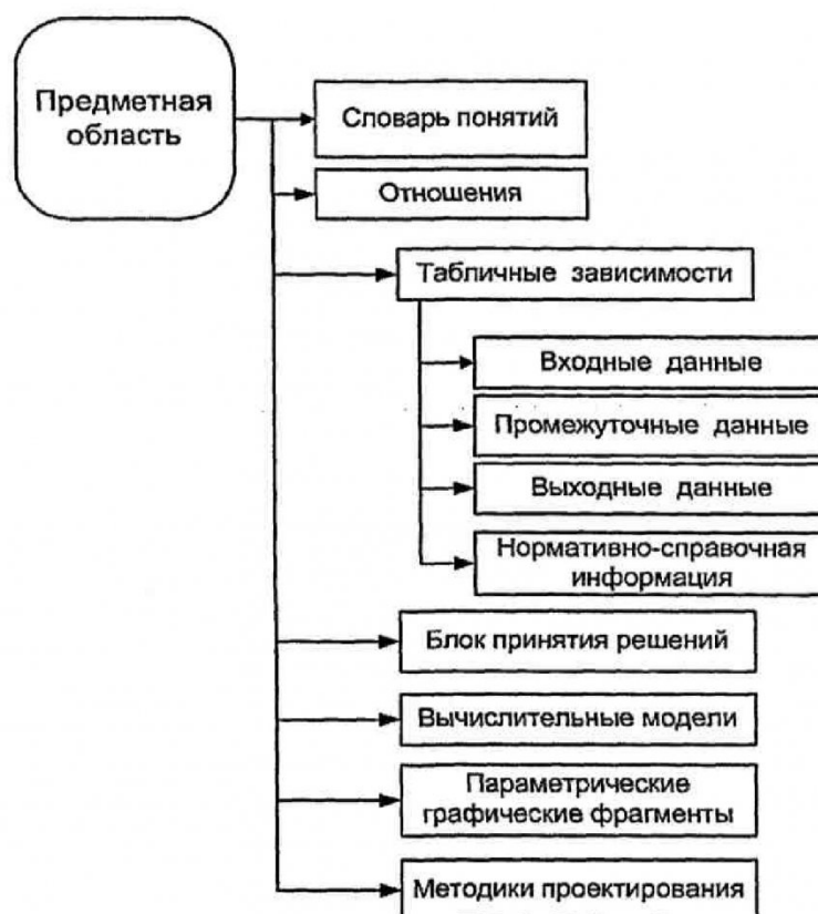
Рис. 5. Структура представления знаний об объектах машиностроения в компьютерной среде
