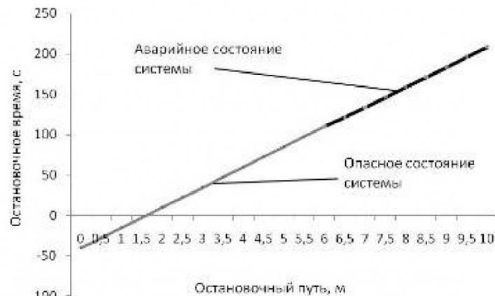
Рис. 1 . Состояния системы ВАДСУ, в зависимости от остановочного пути автомобиля и остановочного времени
