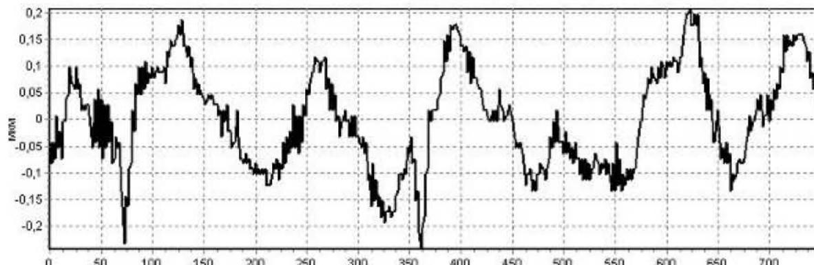
*Рис. 2. Профилограмма выглаженной поверхности образцов из алюминиевого сплава АЛ-2:  $R_a=0,17$  мкм,  $S_m=0,05$  мм,  $t_p=49,7$*
