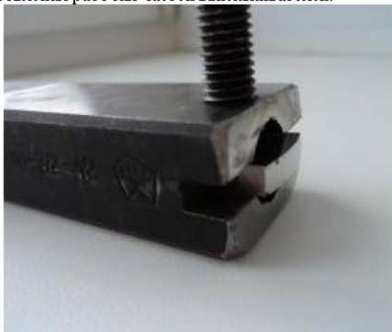
*Рис. 1. Рабочая часть выглаживателя*
