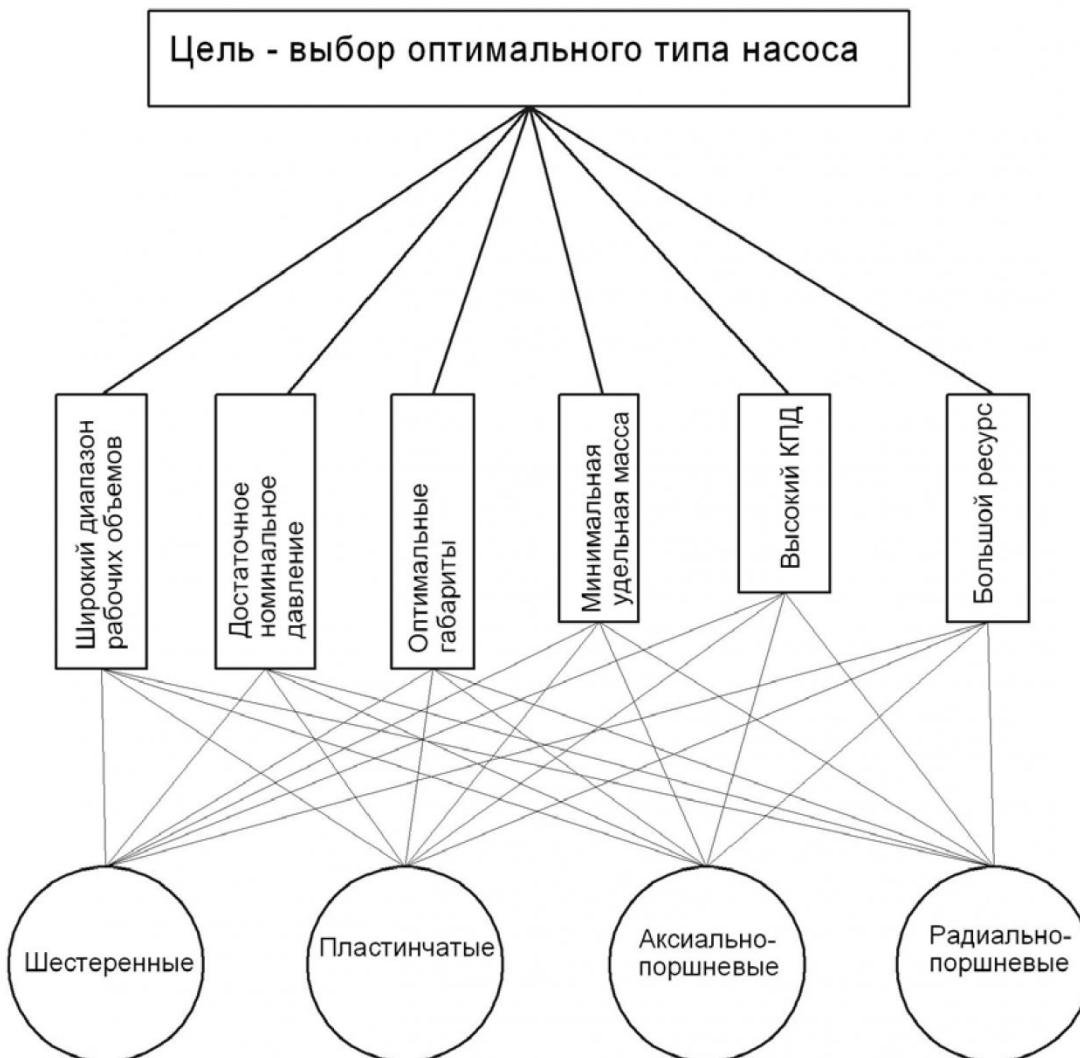
Рис.1 Иерархия задач о выборе подходящих вариантов компоновочных схем ЭСУ
