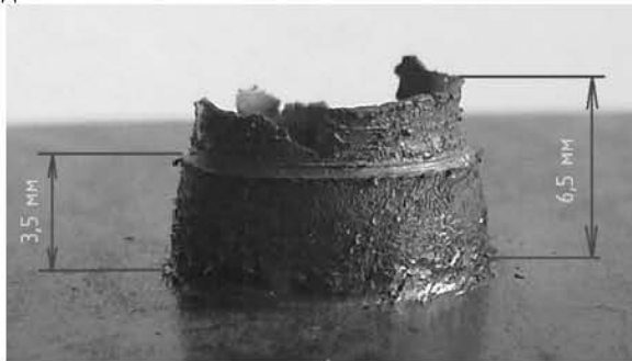
Рис. 5. Нижняя часть крепежного элемента (подача 160 мм/мин; инструмент с криволинейной формой рабочей части)
