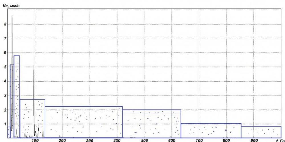
*Рис. 1. Спектр вибрационного сигнала по параметру виброскорости, разделенный на 8 частотных полос с заданными предельно допустимыми значениями для каждой полосы.*
