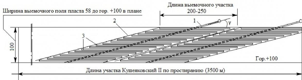
Рис/6 – Схема раскрытия пласта 58 до горизонта +100 м (вид в плане): 1 – уклон; 2 – граница выемочного участка; 3 – выемочная камера;  $\gamma$  – угол между осью уклона и линией простираия пласта
