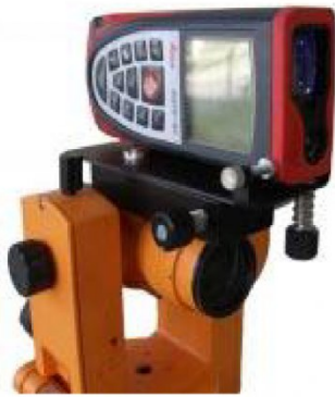
Рис. 3. Крепление лазерной рулетки на трубу теодолита устройством УП-1
