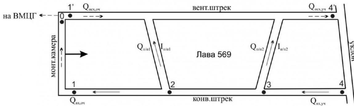
Рисунок 5 - Восходящая схема проветривания выемочного участка № 569
