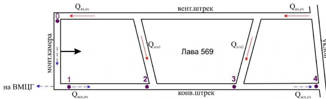
Рис. 1 - Нисходящая схема проветривания выемочного участка № 569
