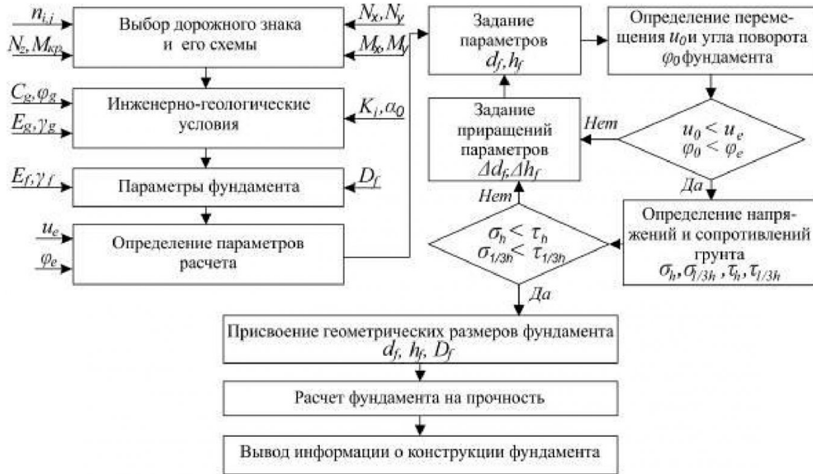
Рис. 1. Алгоритм определения высоты h_f и глубины заложения d_f фундамента:
