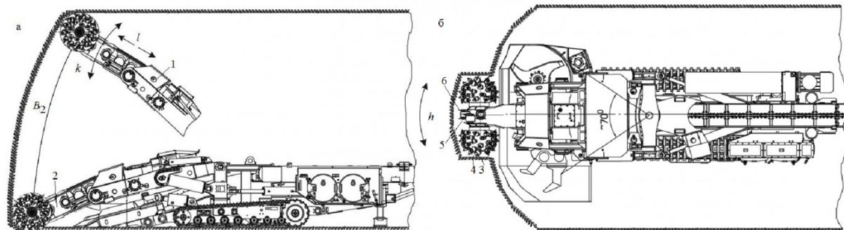
Рис. 2. Схема работы проходческого комбайна избирательного действия:
