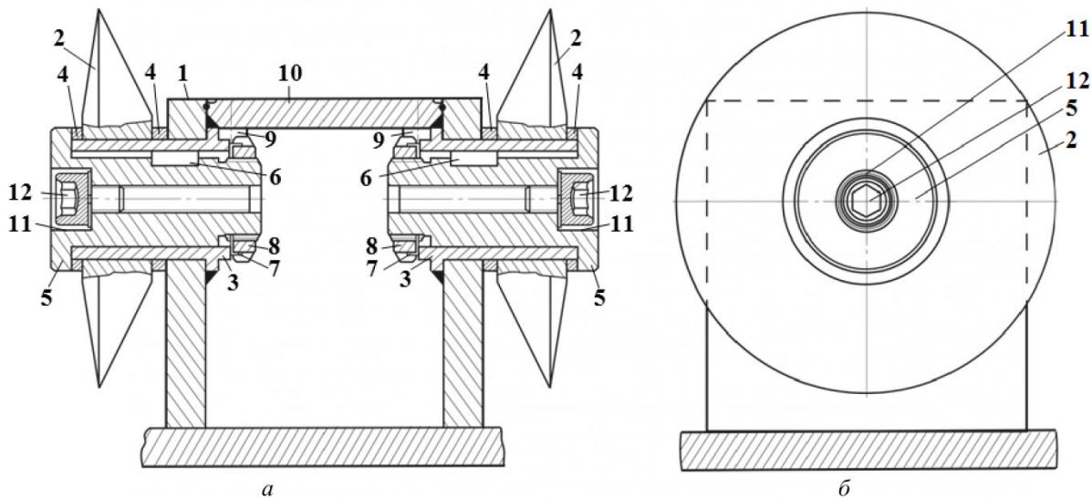
Рис. 3. Конструкция четырехгранной призмы с двумя дисковыми инструментами:
