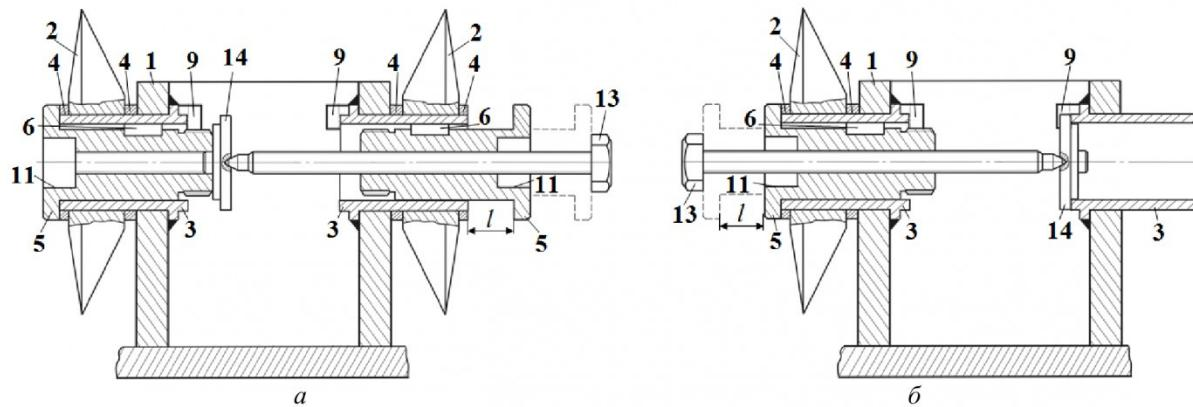
Рис. 4. Демонтаж узлов крепления с дисковым инструментом из четырехгранной призмы
