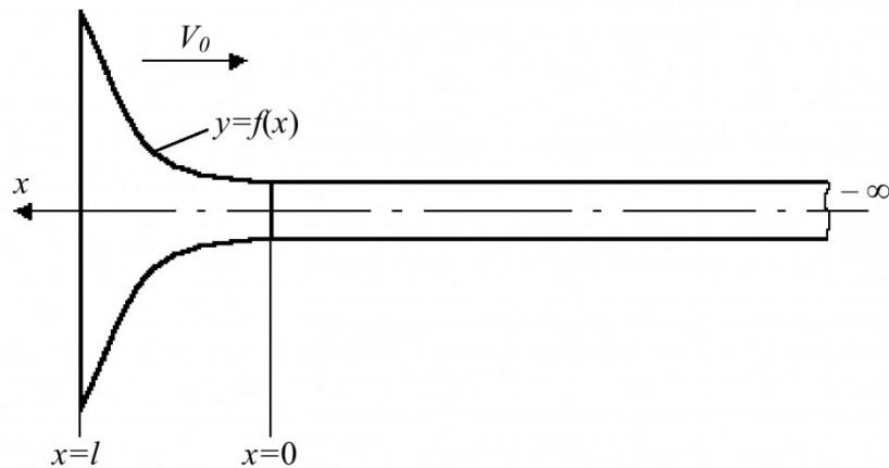
Рис. 1. Расчетная схема соударения бойка и волновода
