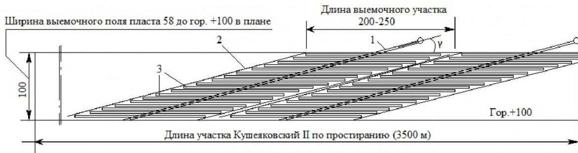
Рис. 6 – Схема раскрыки пласта 58 до горизонта +100 м (вид в плане): 1 – уклон; 2 – граница выемочного участка; 3 – выемочная камера;  $\gamma$  – угол между осью уклона и линией простириания пласта
