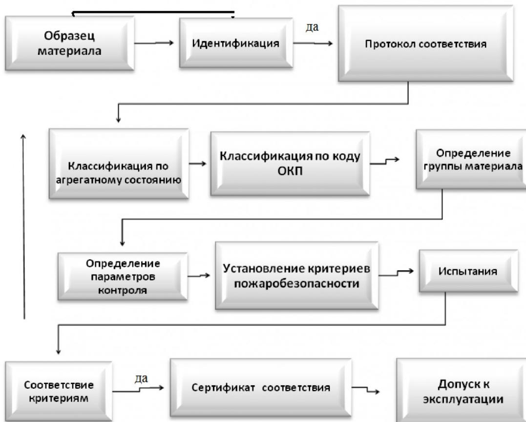
Рис. 2. Алгоритм испытаний полимерных материалов на соответствие требованиям безопасности
