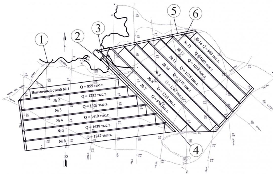
Рис.4. Вскрытие и подготовка модульных шахтоучастков по пласту 67.
