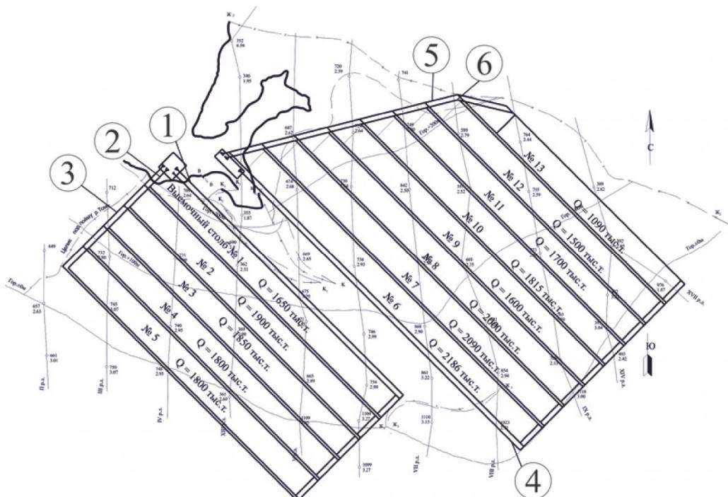
Рис.3. Вскрытие и подготовка модульных шахтоучастков по пласту 66.
