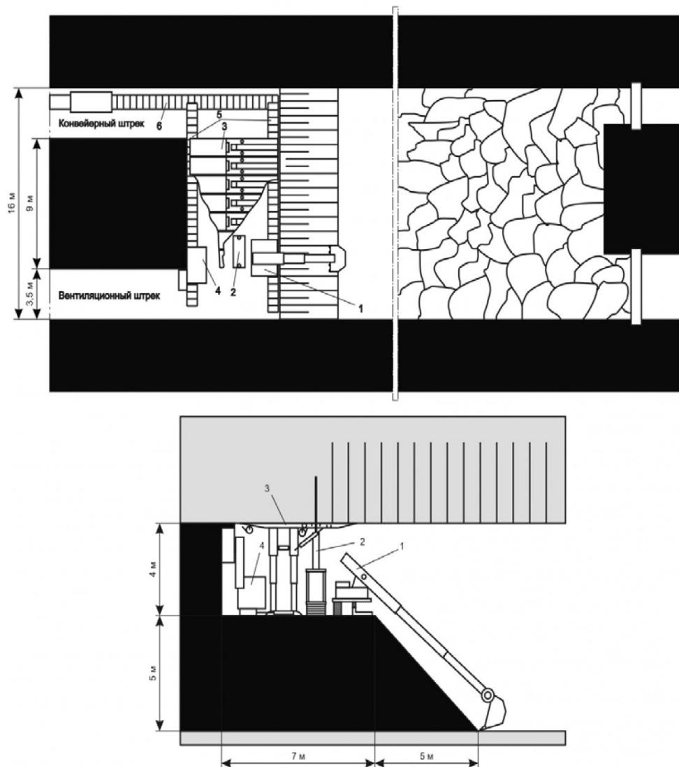
*Рис. 2. Технология отработки мощного полого угольного пласта столбами-камерами*
