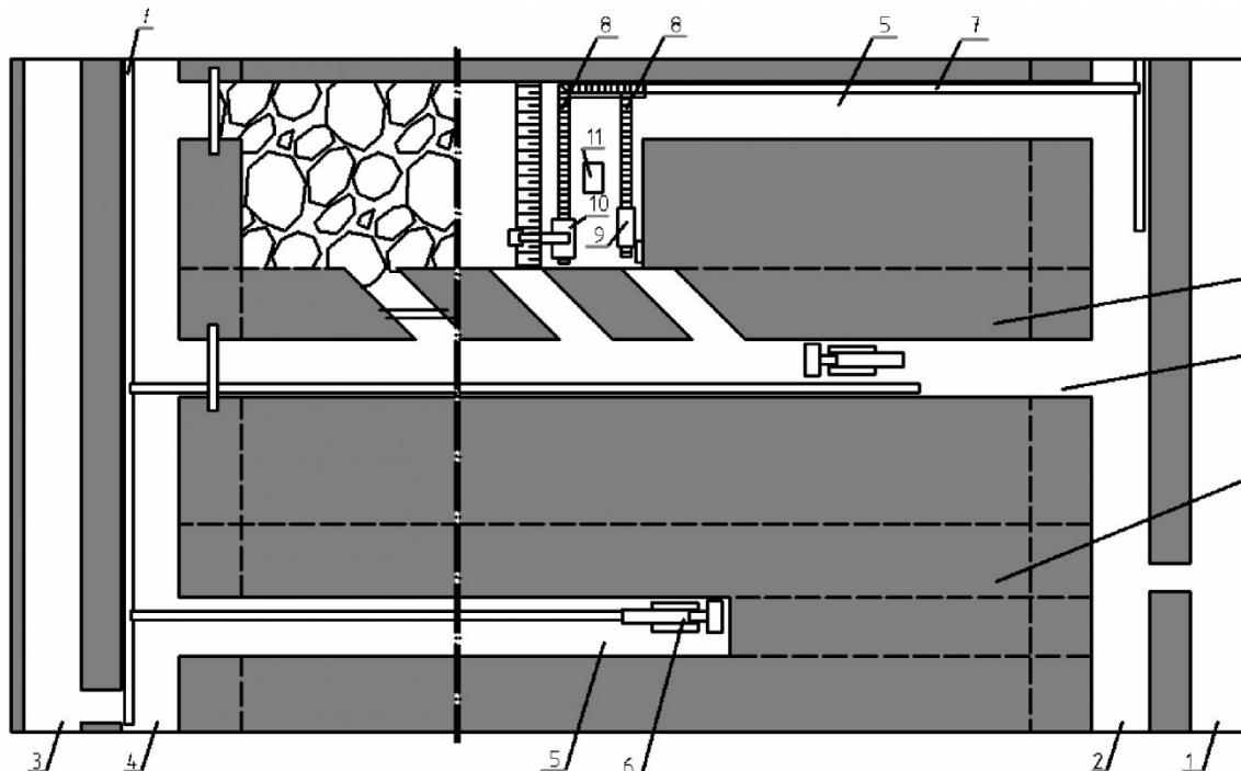
*Рис. 1. Вскрытие, подготовка и отработка мощного пологого угольного пласта столбами-камерами*
