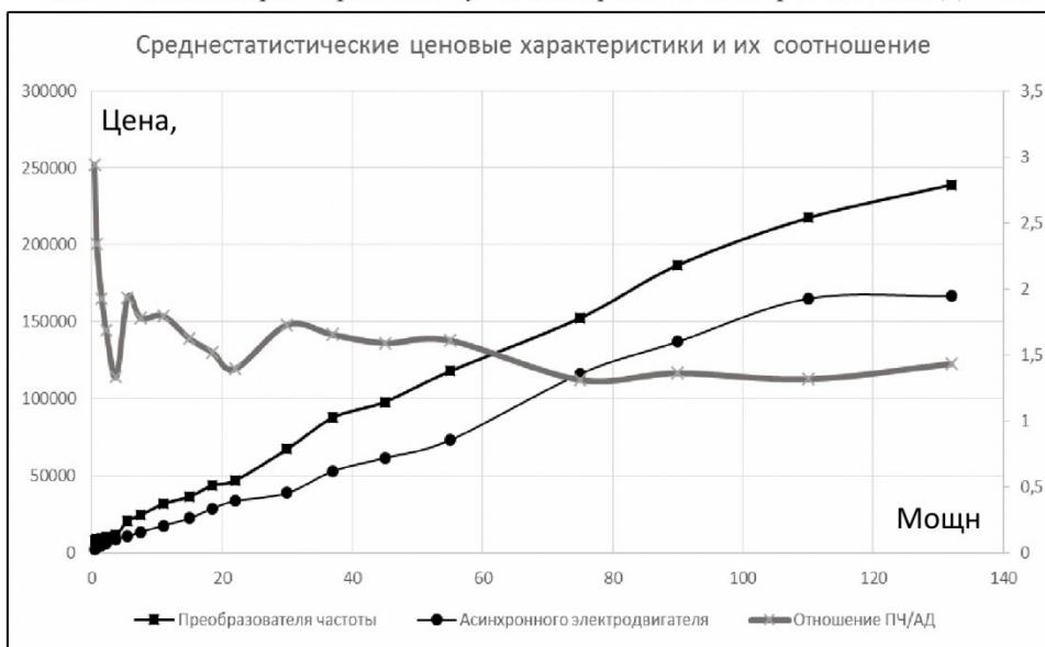
Рис.4. Зависимость цены асинхронного электродвигателя и преобразователя частоты от мощности
